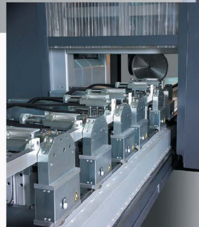
Einzel ansteuerbare autom. positionierbare Spannböcke – programmierbar über die CNC Steuerung
